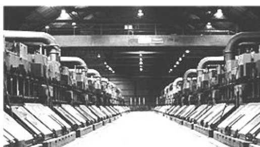
FIG. 49.1 – Salle d'électrolyse pour la production d'aluminium
